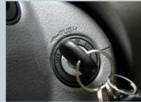
Kunci kontak berfungsi untuk memutus atau menghubungkan arus listrik dari baterai ke sistem pengapian.
